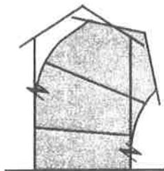
部分破壊し、塑性域に入るが、エネルギーを吸収し破壊しない。
